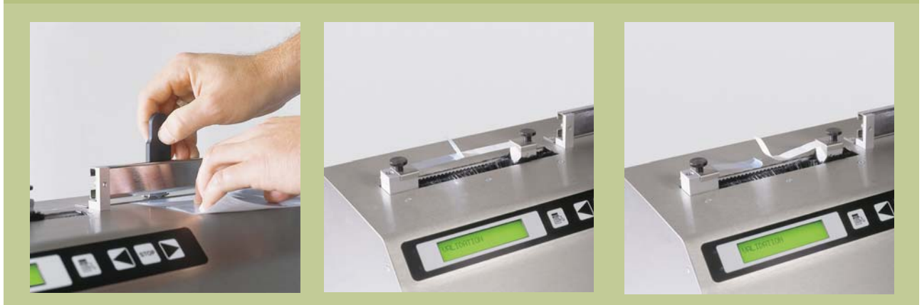
Figura 1 Método exacto de determinación de la resistencia de unión del sellado (Peel Test) de acuerdo con EN 868-5, apéndice D. Realizado por hawotest ht 150 SCD .
