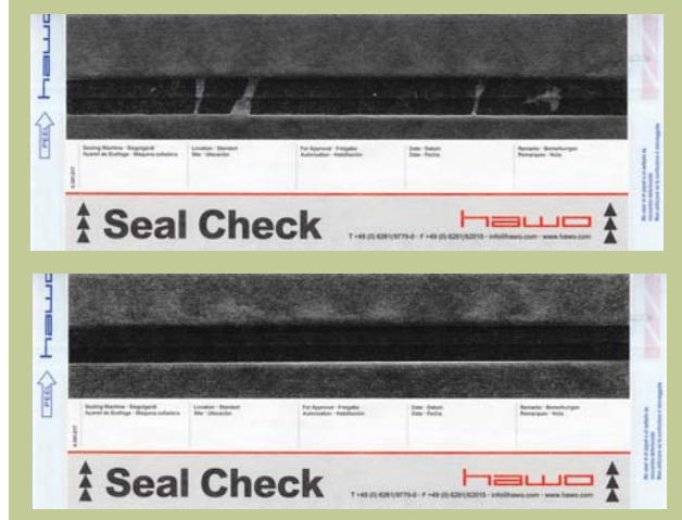
Figura 3 Chequeo de las propiedades de calidad con el Seal Check de hawotest (la imagen sup. muestra un chequeo aprobado y la imagen inf. muestra otro fallido con desgarras).
